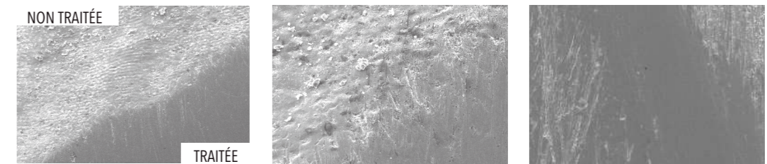
NON TRAITÉE TRAITÉE Surface émaillée non traitée et surface traitée avec Resin PoliStrip 15µm Agrandissement MEB 500x
