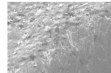
Surface émailée non traitée et traitée avec Resin PoliStrip 15µm agrandissement SEM 2000x.
