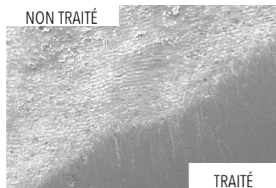
Surface émaillée non traitée et surface traitée avec Resin PoliStrip 15µm Agrandissement MEB 500x
